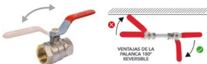
Diseñada para ser desplazada 180°. El giro de cierre y apertura sigue siendo de 90°, pero si hay dificultades de espacio en la instalación, se puede cambiar la posición de esta.
